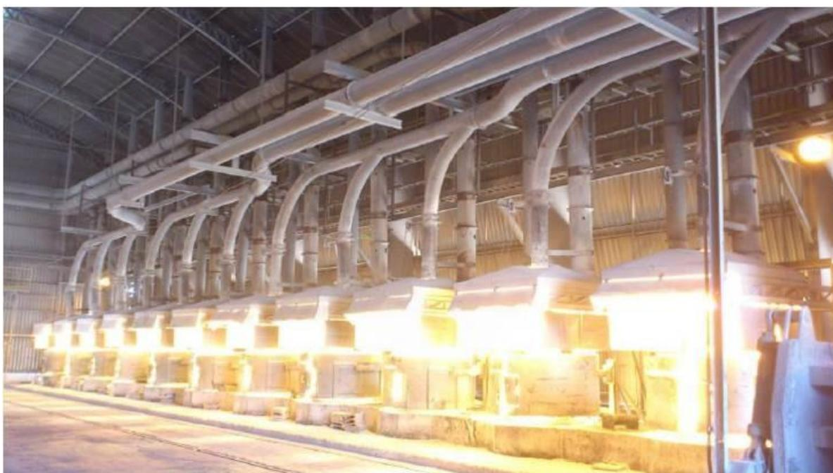
**Figura 9:** Bateria de fornos de produção de Oxido de Zinco
