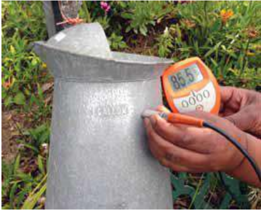
Foto 4: Una regadera galvanizada en caliente utilizada en el área de Constantia en Ciudad del Cabo, Sudáfrica. Comprada en 1963 (50 años) todavía indica una lectura de espesor de revestimiento de 85µm. Para el espesor del acero de 2,0 mm, esto supera con creces los requerimientos de la normativa.
