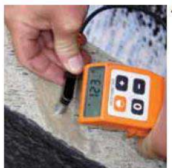
Foto 37: Goedehoop Colliery después de 17 años de exposición. Foto 38: Torre de transferencia. Foto 39: Lavadora de carbón. Foto 40: Revestimiento Dúplex con trazos cruzados. Fotos 41-42: Espesor total del revestimiento 337 \mu\text{m} y espesor del revestimiento galvanizado por inmersión en caliente 123 \mu\text{m} . Nótese que la pintura tuvo que quitarse para medir el espesor del galvanizado.
