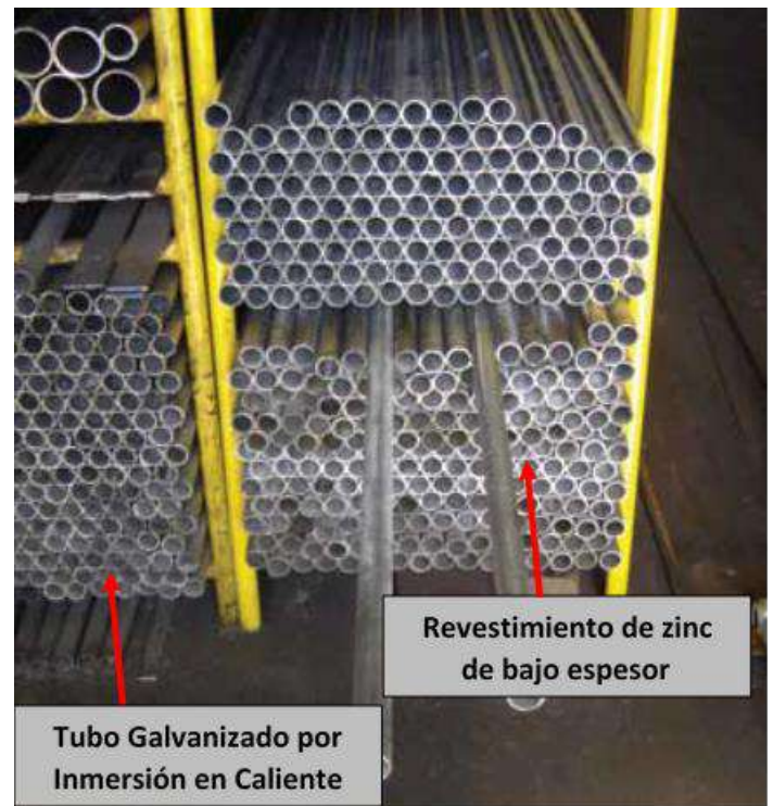
Foto 1: Tubo galvanizado por inmersión en caliente y tubo con revestimiento de bajo espesor
