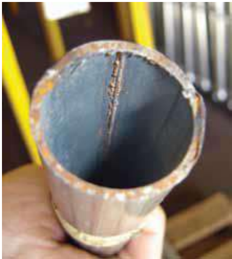
Fotos 2 - 5: Espesor del revestimiento superior externo (22,3 \mu\text{m} ), espesor del revestimiento inferior externo (13,9 \mu\text{m} ), espesor del revestimiento inferior interno (4,9 \mu\text{m} ) espesor del revestimiento superior interno (10,1 \mu\text{m} ). Foto 6: Decoloración en ambos extremos del tubo y en cordón interior del área soldada por arco. El revestimiento de zinc tiene la capacidad de proteger acero actuando como barrera y como metal de sacrificio. Sin embargo, la vida útil del revestimiento de zinc está determinada en ambos casos por su espesor y por el entorno al que se expondrá. (Ver la pérdida típica de revestimiento de zinc en relación con el entorno en la Tabla 2). Fotos 7 - 9: Espesor del revestimiento galvanizado por inmersión en caliente según EN 10240 (91,8; 93,8 y 71,0 \mu\text{m} respectivamente) en el lote inferior de tubos, en comparación con los de las fotos 2 a 5. Fotos 10-11: Espesor del revestimiento galvanizado por inmersión en caliente en los puntales (59,2 y 74,6 \mu\text{m} ). Estos valores son normales de acuerdo con la norma ISO 1461. Foto 12: Puntales galvanizados por inmersión en caliente según ISO 1461.
