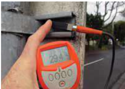
Fotos 1 a 3: Ubicación, sección transversal y espesor de revestimiento típicos de un perfil galvanizado por inmersión en caliente en sistema continuo de 1,6 mm de espesor.
