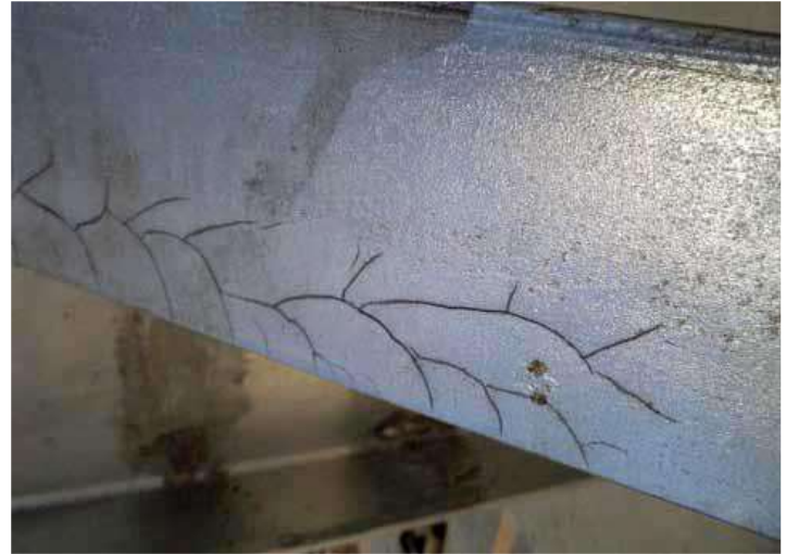
Foto 1: Niveles de fósforo fuera de rango pueden causar grietas severas en el revestimiento.
