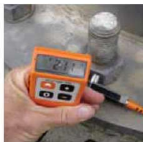
Fotos 47-48: Los mástiles perimetrales de Petro SA cerca de Mossel Bay que se instalaron desde el inicio de la planta (25 años). Fotos 49-50: Espesor del revestimiento en la tuerca de sujeción (211 µm) y en el mástil (159 µm) respectivamente.
