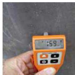
Fotos 47-48: Los mástiles perimetrales de Petro SA cerca de Mossel Bay que se instalaron desde el inicio de la planta (25 años). Fotos 49-50: Espesor del revestimiento en la tuerca de sujeción (211 µm) y en el mástil (159 µm) respectivamente.
